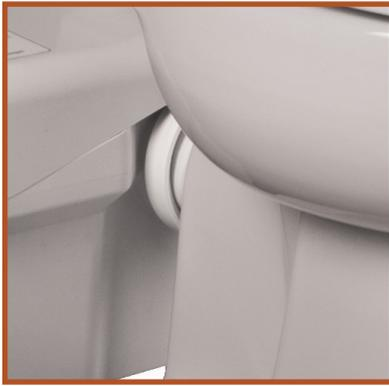
El sello CleanConnect™ elimina acopladores y abrazaderas de manguera antiestéticos tipo acordeón de goma para la conexión del inodoro a la unidad maceradora. Solo debe deslizar la unidad maceradora con un sello integral robusto sobre el buje del inodoro. El macerador se ubica más cerca del inodoro para brindar un aspecto más profesional.
